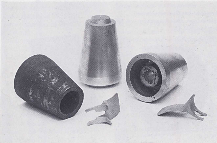
Gietijzeren poelies en bronzen draadleiders t.b.v. Vezelinstituut.
