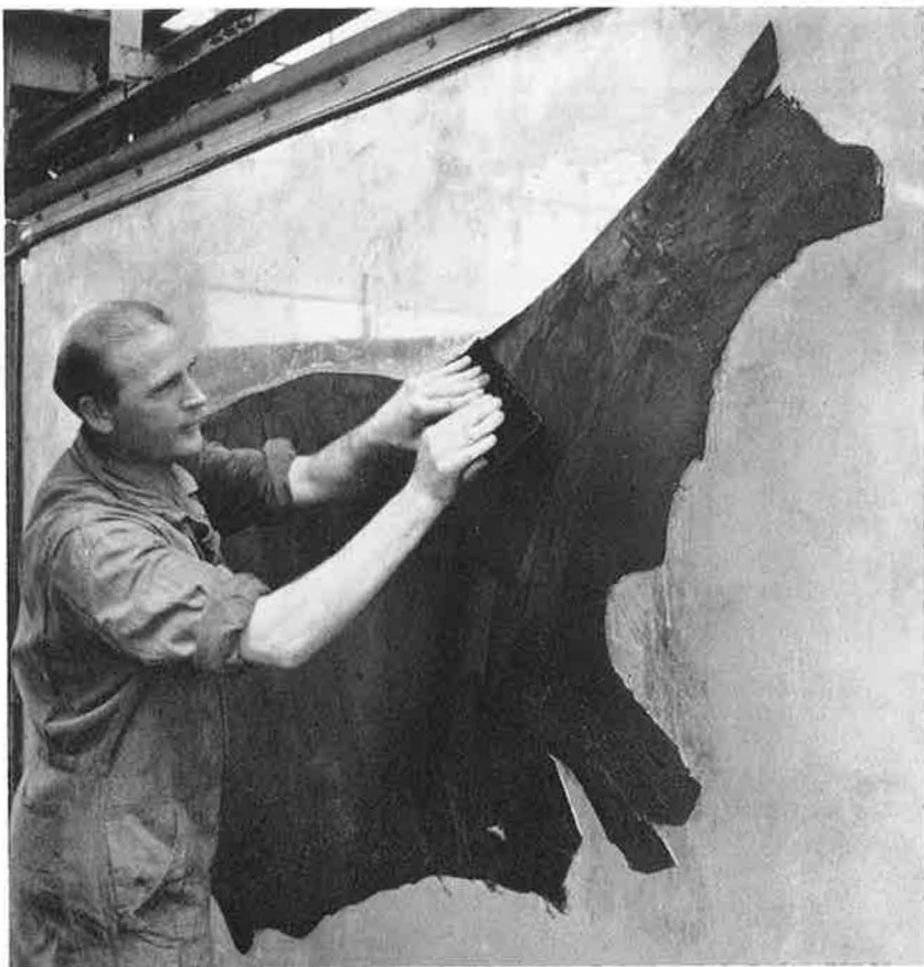
Het leer dat nat uit de looikuipen komt wordt op glasplaten geplakt en in een droogmachine gebracht
