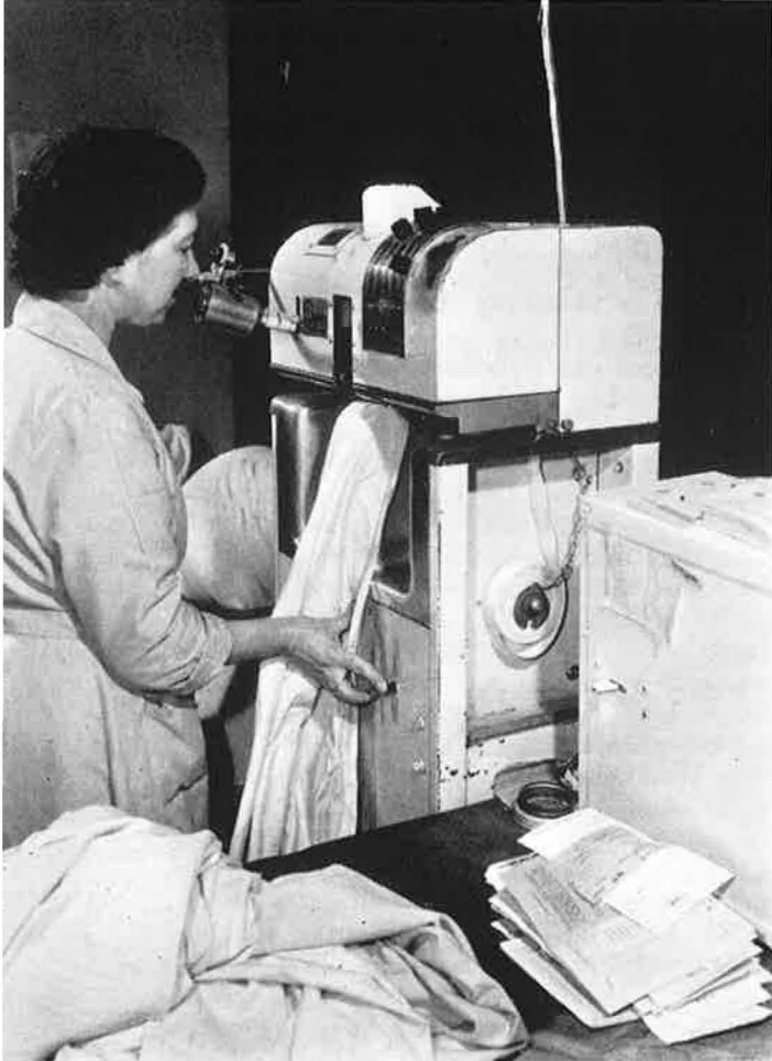
Het binnenkomende wasgoed wordt machinaal gecodeerd; gelijktijdig wordt de naam van het stuk genoemd en door een dicteerapparaat geregistreerd
