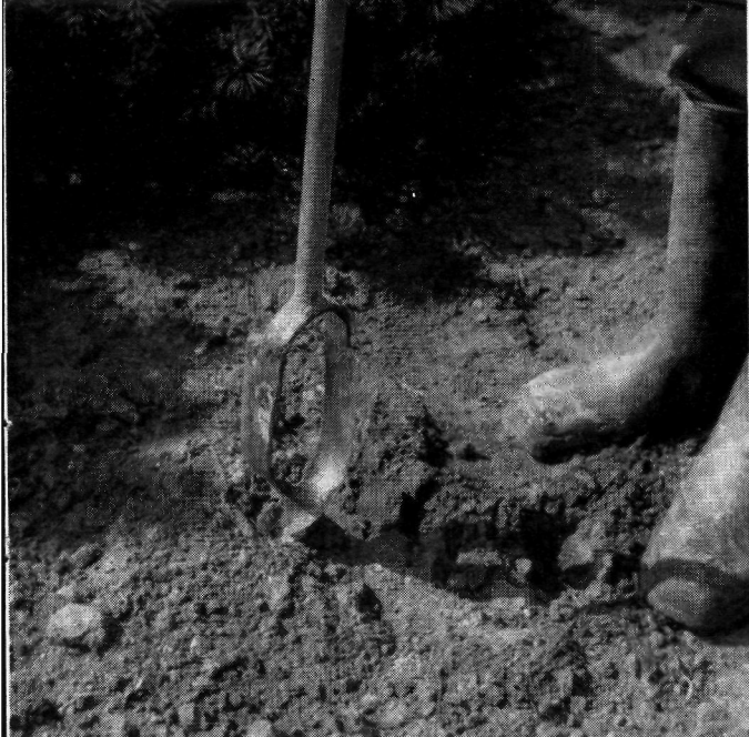
In de vaste grond - bijvoorbeeld klei - wordt met de grondboor gewerkt.
